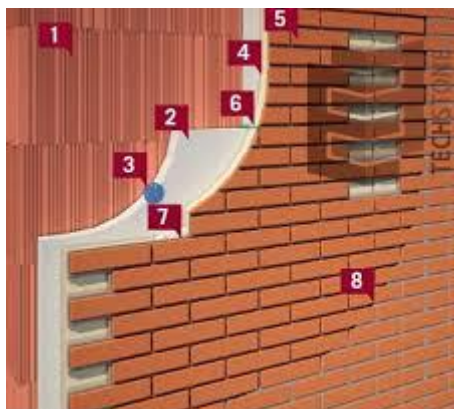
Detalii montaj panouri imitație cărămidă marca Techstone. Montaj realizat pe termosistem de 10 cm, deja existent pe casa.
